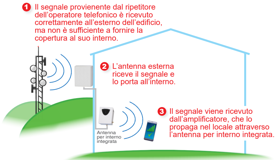
Fig.2 Funzionamento sistema per segnale telefonia (art. 39-105K)
