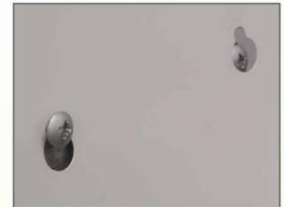
Particolare del fissaggio del disco mediante fori asolati
