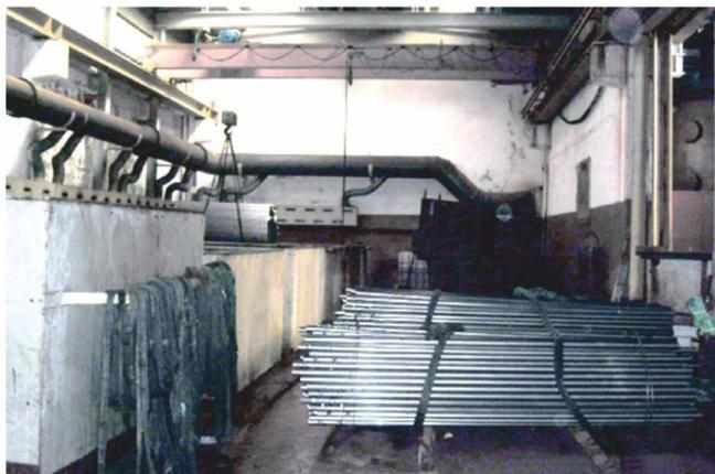
decapaggio in acido cloridrico
