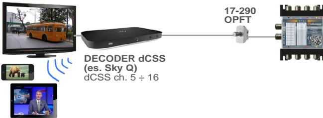
Ai modelli TV-SAT è possibile collegare anche decoder Legacy ed in quel caso a quella uscita derivata non sarà possibile collegare nessun altro tipo di decoder.
