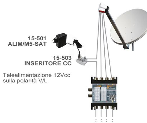
Nei modelli TV-SAT, è necessario collegare l'inseritore di tensione e l'alimentatore tra l'LNB ed il primo multiswitch, connettendolo sulla polarizzazione V/L o su quella V/H.
