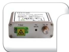
Particolare connettori FO-RX DTT
