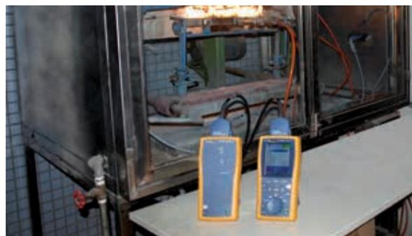
NOTA: Tenuto conto della tolleranza ammessa dalla norma di prova (EN50289-4-16), il cavo supera il test per il "PERMANENT LINK" per collegamenti fino a 69 m.
