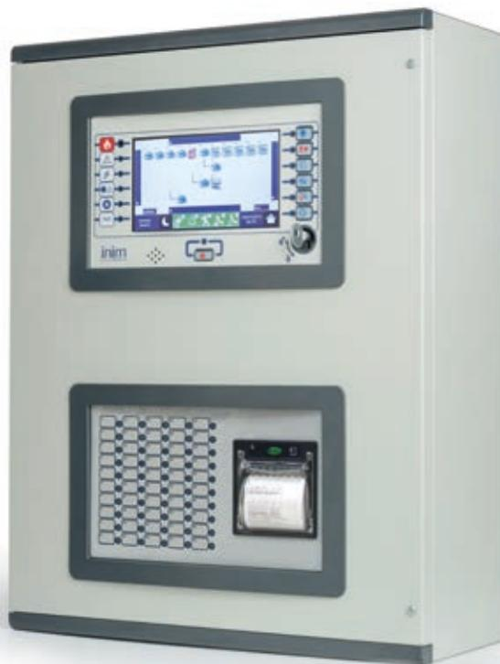
Praesidia è un sistema modulare per la realizzazione di sistemi rivelazione e spegnimento incendi. Le centrali Praesidia possono essere composte da un singolo armadio o da più armadi (max. 4) agganciati tra loro. Le centrali possono essere utilizzate singolarmente oppure interconnesse in rete. La connessione in rete può avvenire tramite BUS RS485, tramite connessione TCP-IP o utilizzando una combinazione di entrambe.
