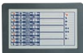
Modulo indicatore LED per sistemi di spegnimento. Qualora nella centrale vengano alloggiati dei moduli funzione IFMEXT è obbligatorio utilizzare uno o più FPMEXT per visualizzarne lo stato come indicazioni separate dal display. Ciascun modulo FPMEXT fornisce le indicazioni di 5 moduli di spegnimento IFMEXT. Va inserito nel pannello frontale e si collega alla barra CAN DRIVE se alloggiato nell'asola superiore, oppure al modulo FPM nell'asola superiore se alloggiato nell'asola inferiore.
