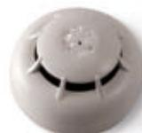
Il rivelatore può essere però impostato nelle modalità: A1R (soglia fissa a 58°C e rivelazione termovelocimetrica), B (Soglia fissa a 72°C), A2S (Soglia fissa a 58°C), BR (soglia fissa a 72°C con rivelazione termovelocimetrica). Grazie alla sua alta versatilità può essere adattato a tutte quelle condizioni dove la rivelazione del fumo risulta difficile e suscettibile di falsi allarmi.
