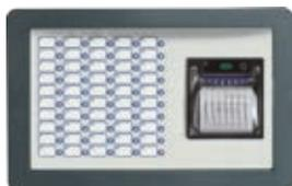
Modulo dotato di 50 led 3 colori come l'articolo FPMLED e di una stampante termica su rotolo da 80mm. Permette la stampa in tempo reale degli eventi registrati dal sistema. Va inserito nel pannello frontale e si collega alla barra CAN DRIVE se alloggiato nell'asola superiore, oppure al modulo FPM nell'asola superiore se alloggiato nell'asola inferiore.
