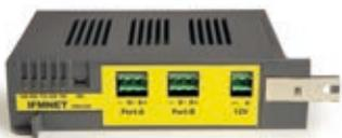
Modulo per il collegamento di due o più centrali in rete Hornet+, fino ad un massimo di 48. Il modulo fornisce due porte RS485 per il collegamento con le altre centrali; il cablaggio va realizzato ad anello chiuso. Velocità della RS485 impostabile da 9600 a 512k baud, fornita una uscita 12V per alimentare eventuali convertitori RS485-Fibra ottica. Ciascuna centrale gestisce un solo modulo IFMNET. Tutte le centrali interconnesse in rete devono alloggiare un modulo IFMNET.
