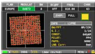
Costellazione Ruotata DVB-T2 (opz.) modulazione 256 QAM, a destra i relativi parametri di modulazione e M-PLP
