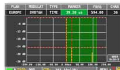
MISURE ECHM in reti SFN, con impulse response in tempo reale, l'area verde mostra l'intervallo di guardia
