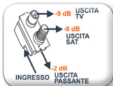
Schema di funzionamento di una presa OPS6 DEM TV/SAT cc (art. 27-534)
