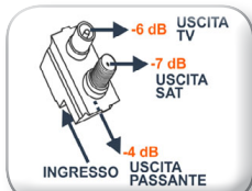
Schema di funzionamento di una presa OPS6 DEM TV/SAT cc (art. 27-534)
